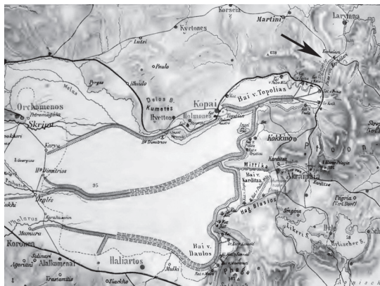
Σχ. 5. Μινυκά έργα αποστράγγισης Κωπαΐδας και η σήραγγα Κεφαλαρίου.
